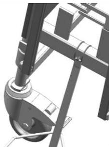
Den zweiten Rohrklappstecker, wie auf dem Bild von außen nach innen gezeigt einsetzen und schließen.
