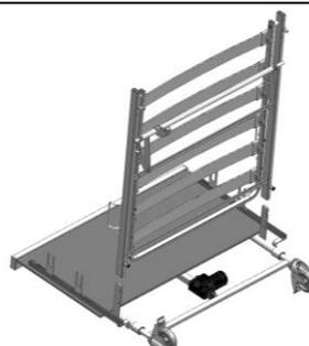
Verbinden Sie die Liegefläche mit dem Endstück, indem Sie die Liegefläche auf die Aufnahmelaschen den Verbinder stecken. Durch leicht diagonales Ansetzen finden sich die Verbindungsaufnahmen leichter und der Aufbau wird rückschönder
