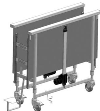
Den Rohrklappstecker, wie auf dem Bild von innen nach außen gezeigt einsetzen und schließen.
