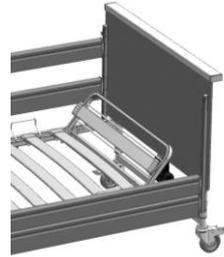
Legen Sie den Verlängerungsbügel ab, so dass sie eben mit dem Fußbügel ist.
