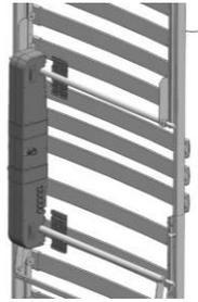
Schieben Sie die Deckplatten seitlich in die Arretierung des Kastenmotors.
